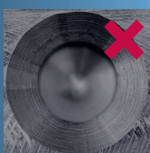
Ruwer oppervlak met een standaard Verzinkboor
