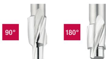
Pour chanfreiner les trous de vis dans différentes versions, avec un angle de 180°, par exemple pour les vis Allen, et avec un angle de 90° pour les vis à plat. En outre, les fraises à chambrer sont disponibles avec ajustement fin et moyen et en pré-taraudage.
